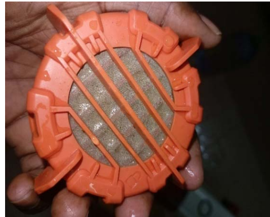
b°) Préfiltre colmaté après usage
