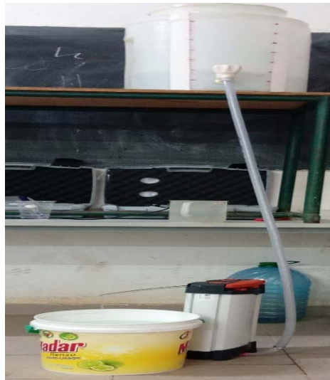
Figure 19: Montage du mode gravitaire
