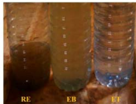
Eaux issues du traitement de Pall Aria AX2
