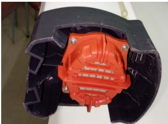
a°) Préfiltre fixé sur le module
